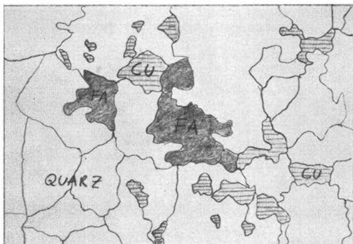
Abb. 11: Fahlerz (FA) mit Kupferkies (CU) eng verwachsen, Gangart Quarz. 72× vergr.
