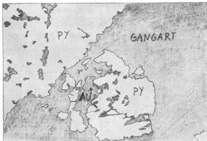
Abb. 22: Kataklastischer Pyrit (PY) mit Freigold (AU). 144× vergr.
